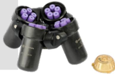
Das regelmäßige Fetten der Rotorbolzen entfällt – dies spart Arbeitszeit und sorgt für ein Höchstmaß an Sicherheit.
