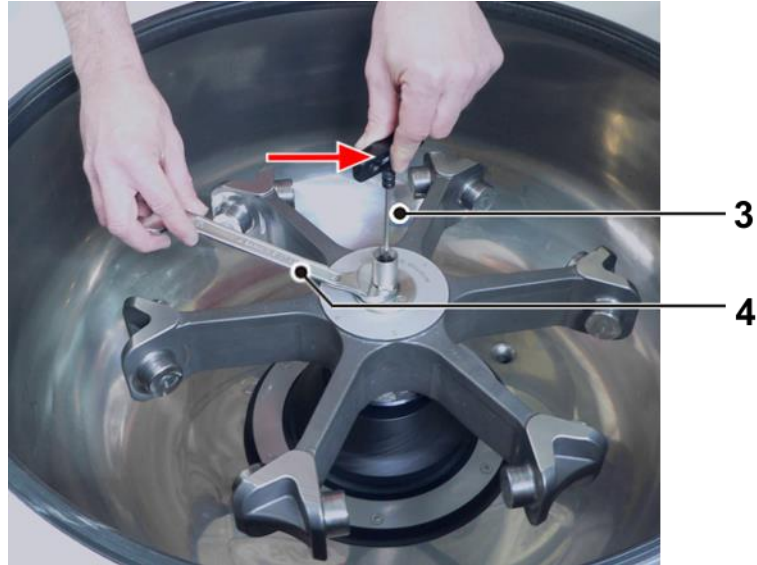
Fig. 13 : « Technique des deux doigts », pour tenir la clé hexagonale
