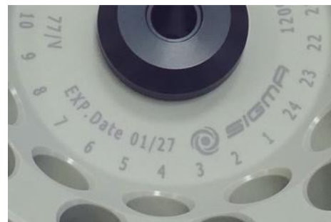
Fig.7 : Indication de la durée de vie spécifique sur une nacelle ou un rotor
