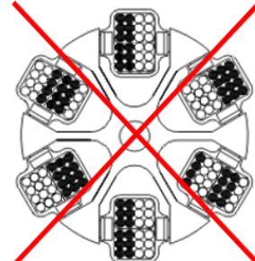
Fig. 16 : Exemples de chargements autorisés et non autorisés d'un rotor libre et d'un rotor angulaire
