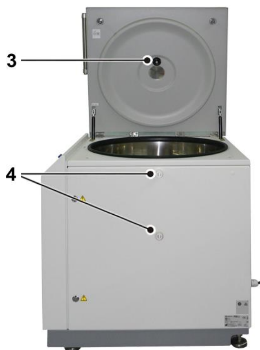
Fig. 11 : Supports possibles pour le couvercle de la cuvette de protection contre le vent
