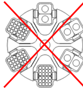
Fig. 15 : Exemples de chargements autorisés et non autorisés d'un rotor libre avec des récipients de tailles différentes
