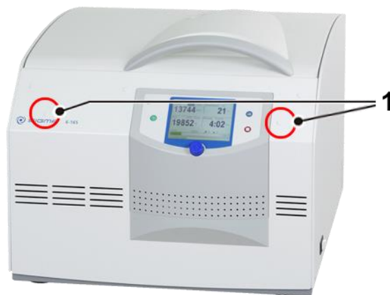
Fig. 34 : Emplacement des orifices du dispositif de déverrouillage d'urgence
