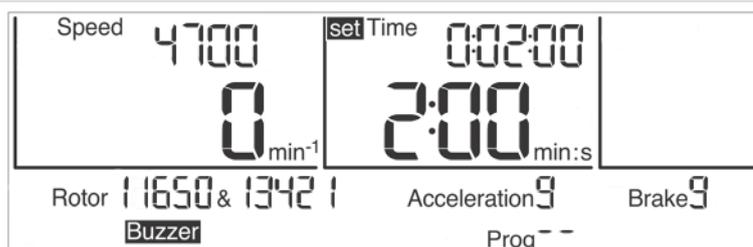
Fig. 18 : Réglage de la durée, ici avec l'unité « min:s »
