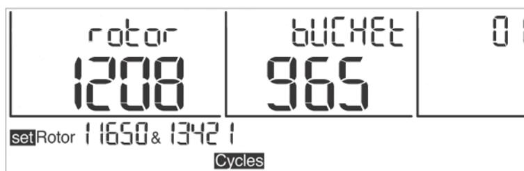
Fig. 30 : Affichage du nombre de cycles pour le rotor 11650 et la nacelle 13421
