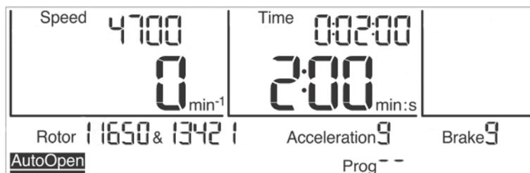
Fig. 27 : L'ouverture automatique du couvercle « Auto Open » est activée
