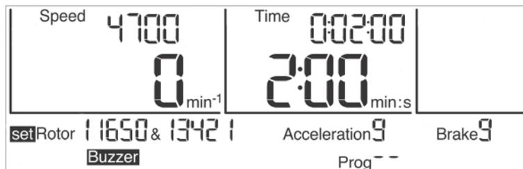
Fig. 25 : Sélection du rotor ou de la combinaison rotor et nacelle
