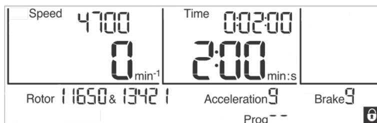
Fig. 32 : Symbole du cadenas lorsque le verrouillage du paramétrage est activé
