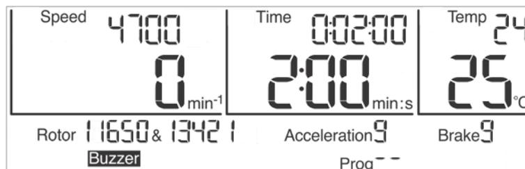
Fig. 24 : Affichage (la valeur maximale enregistrée clignote) en cas de dépassement de la température d'alarme
