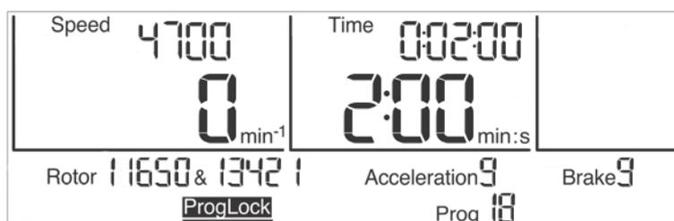
Fig. 29 : Le verrouillage du programme « ProgLock » est activé
