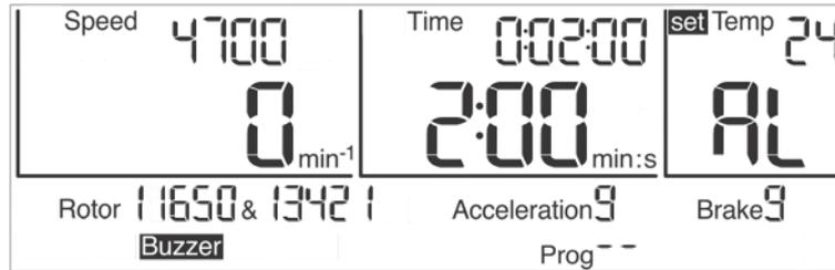
Fig. 23 : Affichage avec surveillance de la température activée
