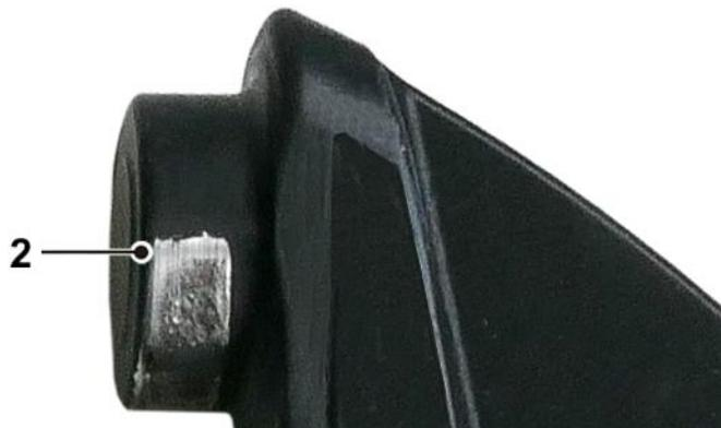
*Fig. 9 : Support de rotor avec revêtement totalement usé – Le graissage est nécessaire*
