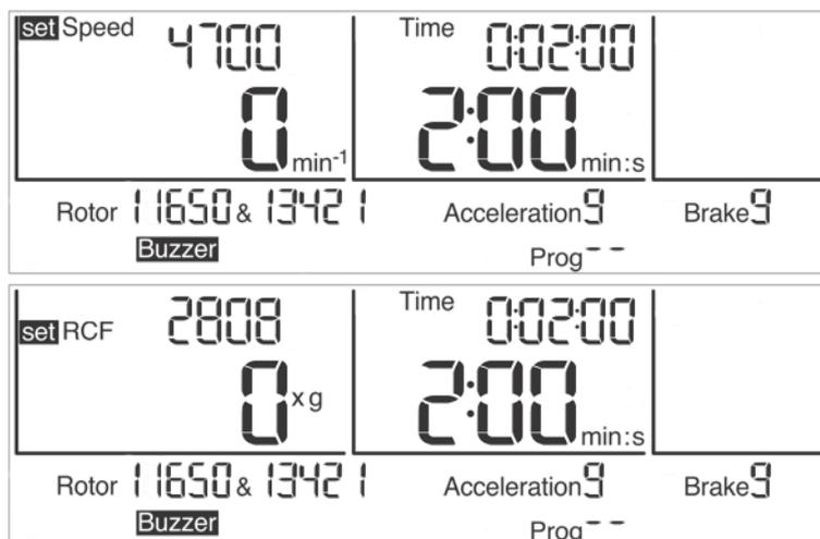
Fig. 17 : Réglage de la vitesse de rotation ou de la FCR
