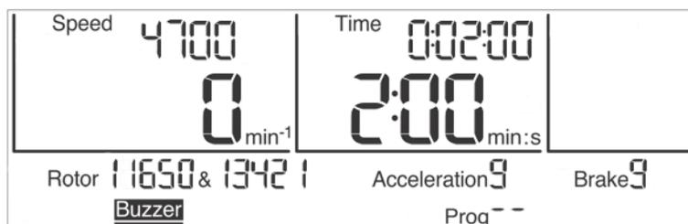
Fig. 28 : Le signal sonore « Buzzer » est activé
