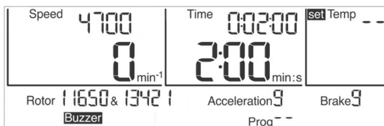
Fig. 22 : Affichage avec surveillance de la température désactivée
