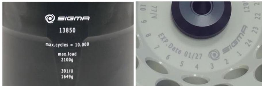
Fig. 6 : Indication de la durée de vie spécifique sur une nacelle ou un rotor
