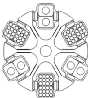
Fig. 11 : Chargement autorisé et non autorisé du rotor libre avec des récipients de tailles différentes (exemple)
