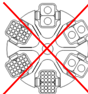
Fig. 11 : Chargement autorisé et non autorisé du rotor libre avec des récipients de tailles différentes (exemple)
