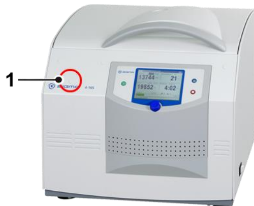
Fig. 33 : Emplacement du dispositif de déverrouillage d'urgence
