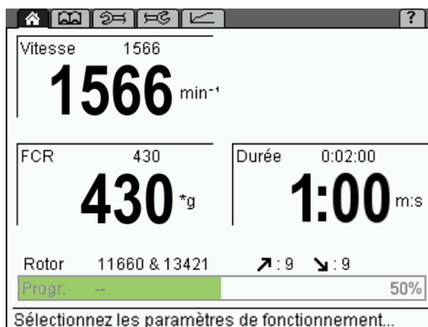
Fig. 19 : indication de la progression au cours de la centrifugation
