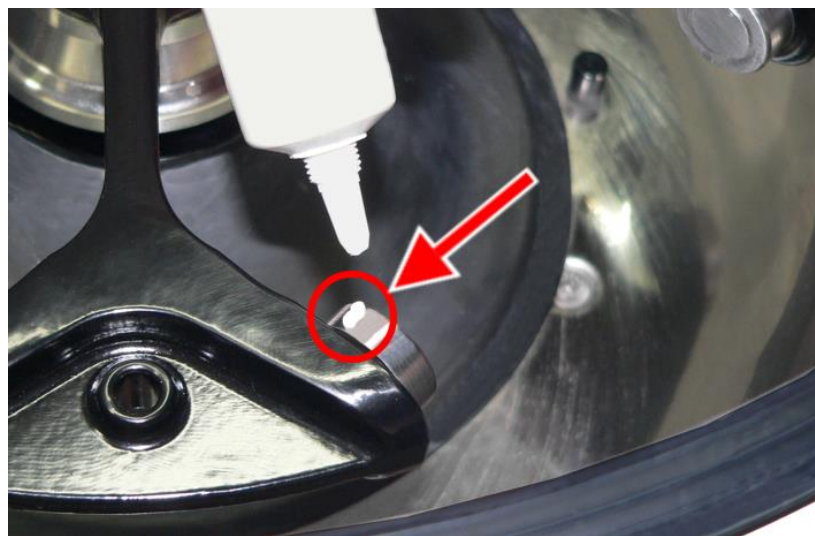
Fig. 36 : Quantité suffisante de graisse pour un support de rotor
