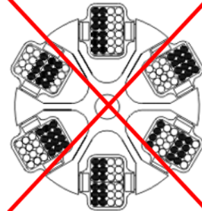
Fig. 12 : Chargement autorisé et non autorisé d'un rotor angulaire et d'un rotor libre (exemples)
