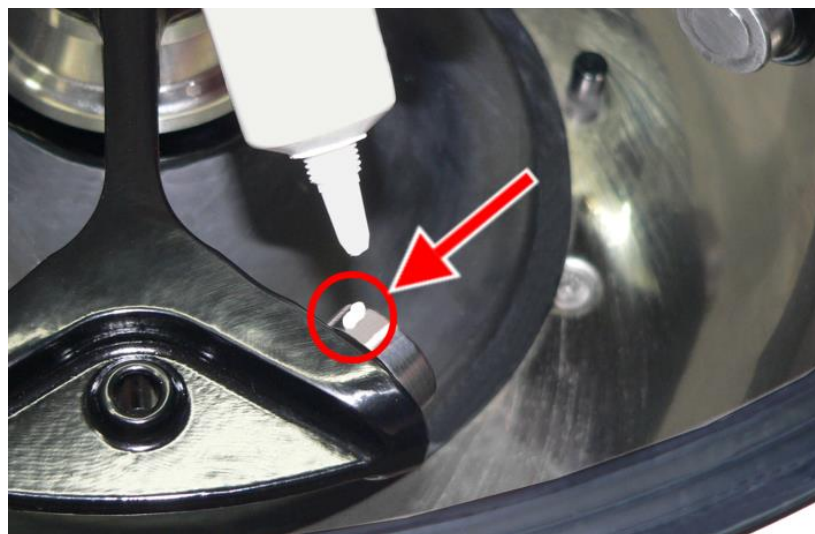
Fig. 37 : Quantité suffisante de graisse pour un support de rotor
