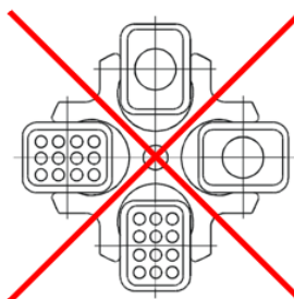
Fig. 12 : Chargement autorisé et non autorisé du rotor libre avec des récipients de tailles différentes (exemple)
