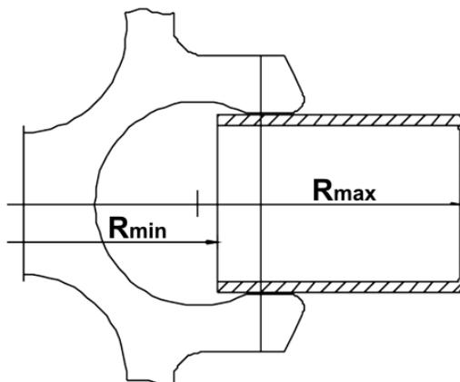
Fig. 37 : Rayons maximal et minimal d'un rotor libre
