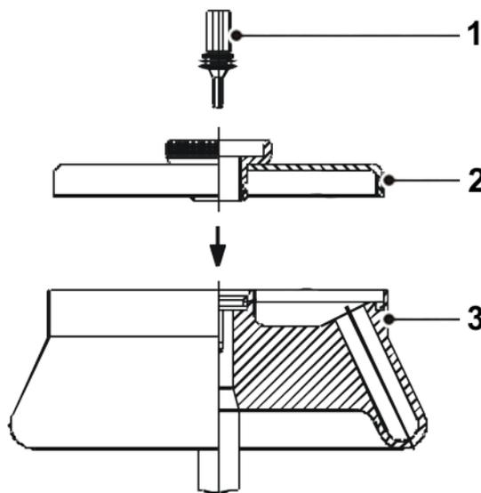
Fig. 9 : Rotor angulaire standard avec couvercle hermétique
