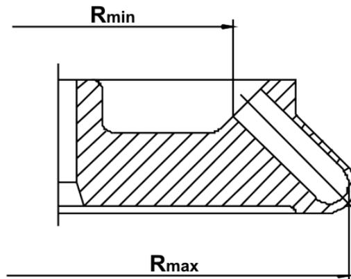
Fig. 36 : Rayons maximal et minimal d'un rotor angulaire
