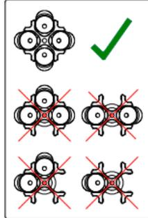
Fig.12 : Consignes de sécurité: chargement d'un rotor libre
