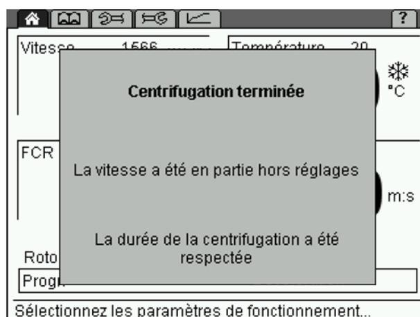
Fig. 22 : Exemple d'un message du contrôle de centrifugation
