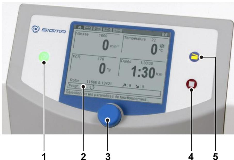
Fig. 13 : Panneau de commande de la centrifugeuse
