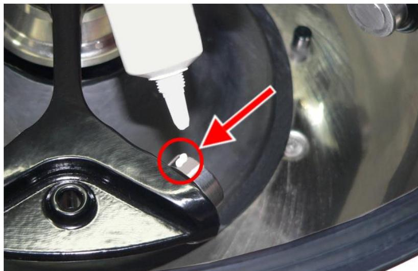
Fig. 35 : Quantité suffisante de graisse pour un support de rotor
