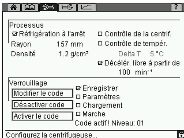
Fig. 23 : Menu Paramètres avec verrouillage actif (niveau 01)
