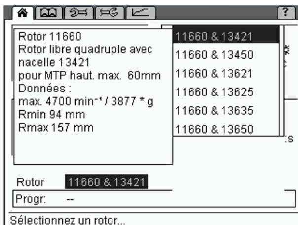
Fig. 16 : Liste de sélection du rotor, ici un rotor libre
