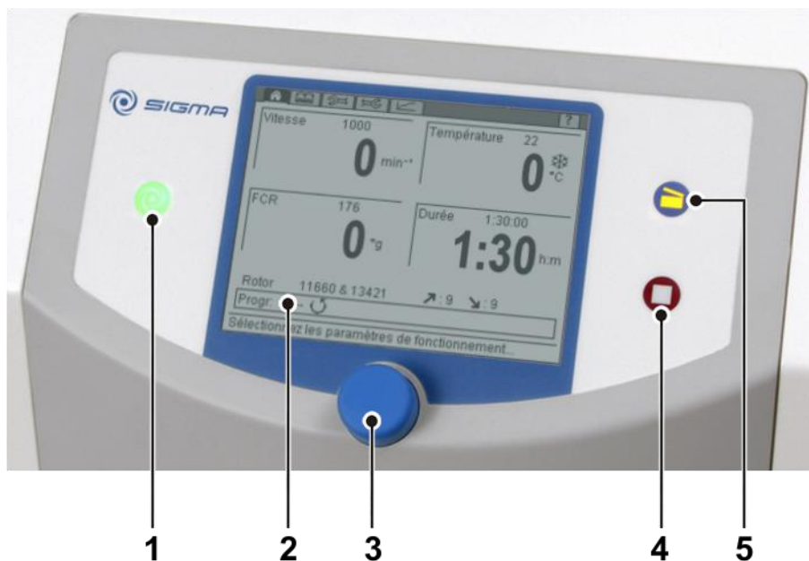
Fig. 13 : Panneau de commande de la centrifugeuse
