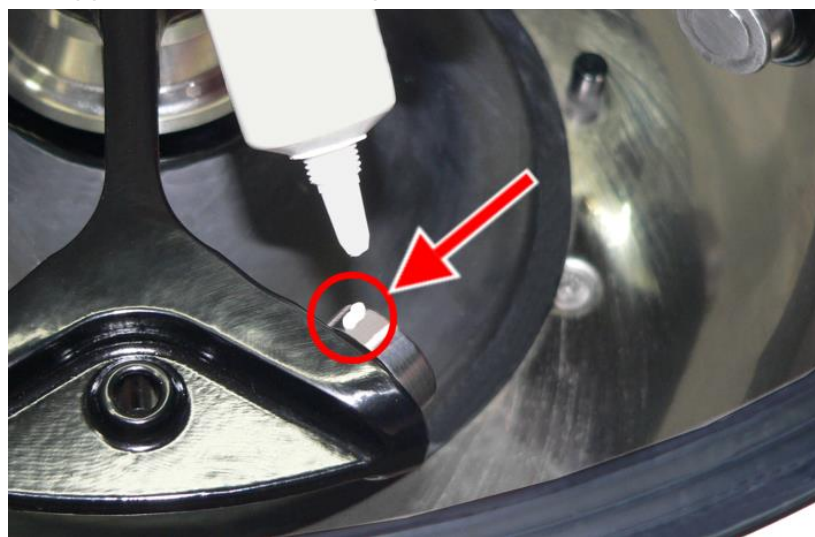
Fig. 34 : Quantité suffisante de graisse pour un support de rotor
