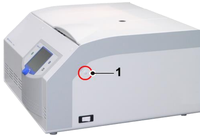
Fig. 33 : Emplacement de l'orifice d'accès au déverrouillage d'urgence
