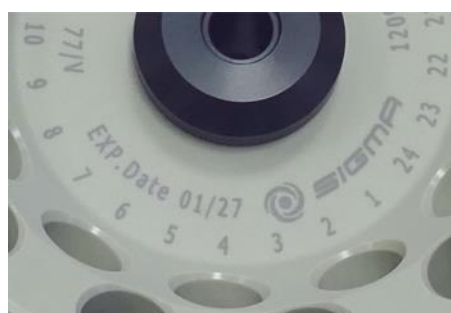
Fig.4 : Indication de la durée de vie spécifique sur une nacelle ou un rotor
