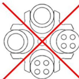
Fig. 10 : Chargement autorisé et non autorisé du rotor libre avec des récipients de tailles différentes (exemple)
