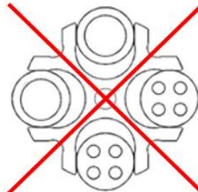
Fig. 12 : Chargement autorisé et non autorisé du rotor libre avec des récipients de tailles différentes (exemple)
