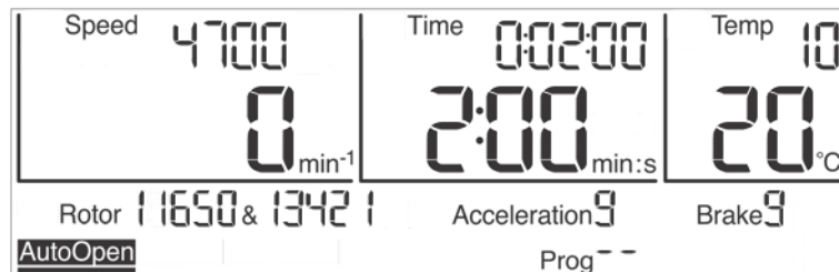
Fig. 26 : L'ouverture automatique du couvercle « Auto Open » est activée
