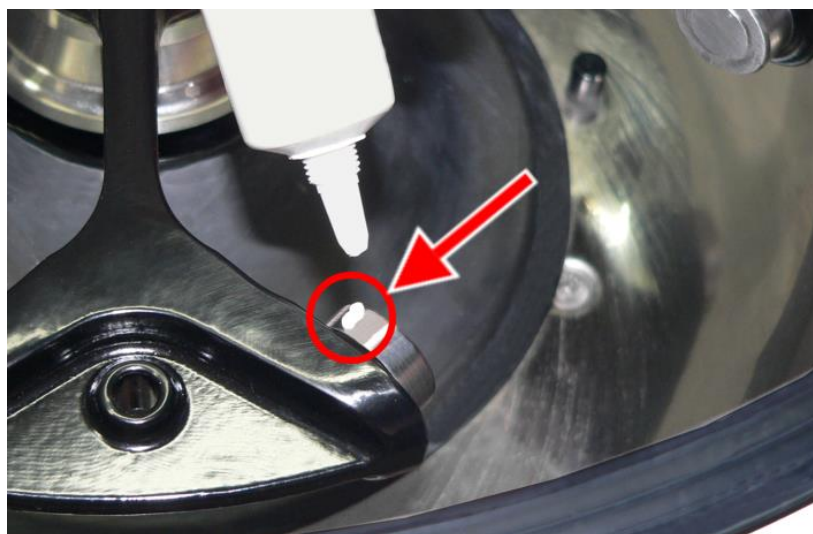
Fig. 35 : Quantité suffisante de graisse pour un support de rotor
