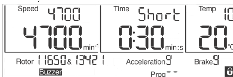
Fig. 21 : Indication « Short » pendant le fonctionnement court
