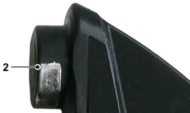
Fig. 9 : Support de rotor avec revêtement usé – Le graissage est nécessaire
