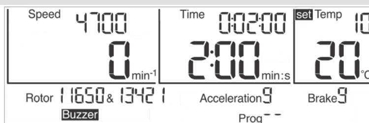
Fig. 22 : Réglage de la température de consigne
