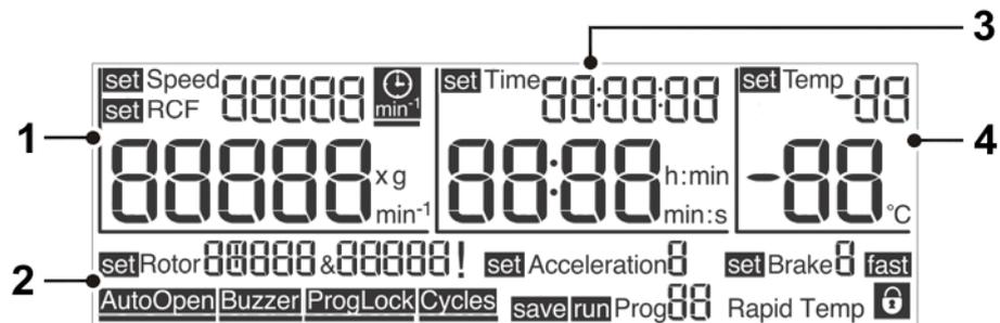
Fig. 15 : Écran du système de commande Spincontrol L
