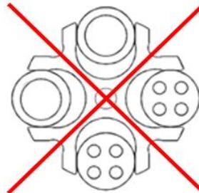
Fig. 11 : Chargement autorisé et non autorisé du rotor libre avec des récipients de tailles différentes (exemple)
