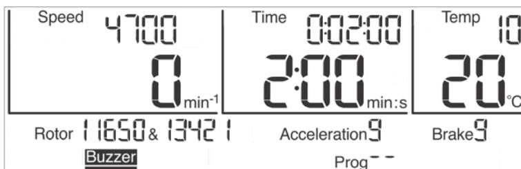
Fig. 26 : Le signal sonore « Buzzer » est activé
