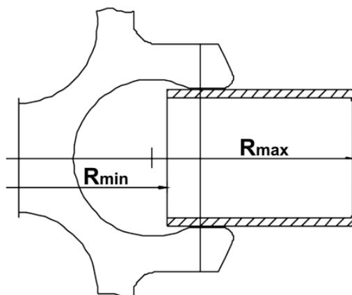
Fig. 36 : Rayons maximal et minimal d'un rotor libre
