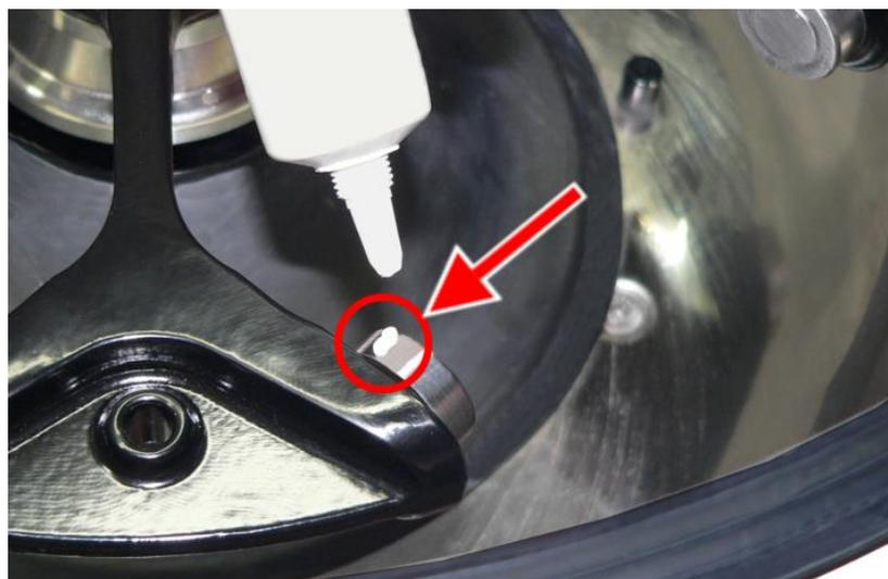
Fig. 34 : Quantité suffisante de graisse pour un support de rotor
