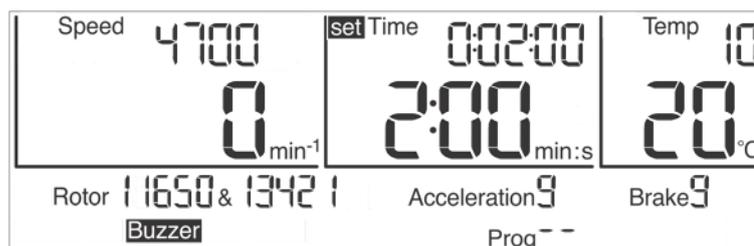
Fig. 17 : Réglage de la durée, ici avec l'unité « min:s »
