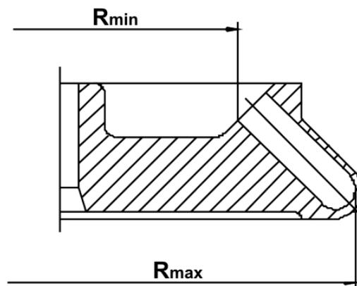
Fig. 35 : Rayons maximal et minimal d'un rotor angulaire
