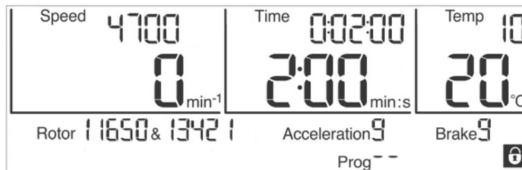
Fig. 30 : Symbole du cadenas lorsque le verrouillage du paramétrage est activé
