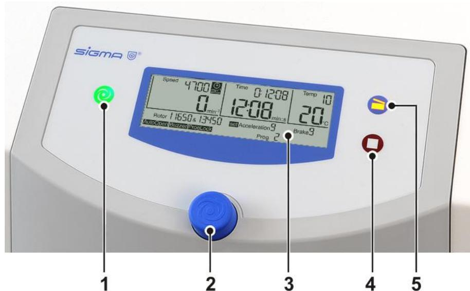
Fig. 14 : Panneau de commande de la centrifugeuse
