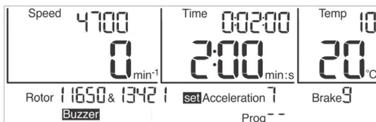
Fig. 24 : Sélection de la courbe ; ici : sélection de la courbe d'accélération
