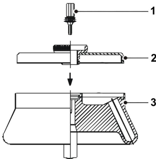
Fig. 10 : Rotor angulaire standard avec couvercle hermétique
