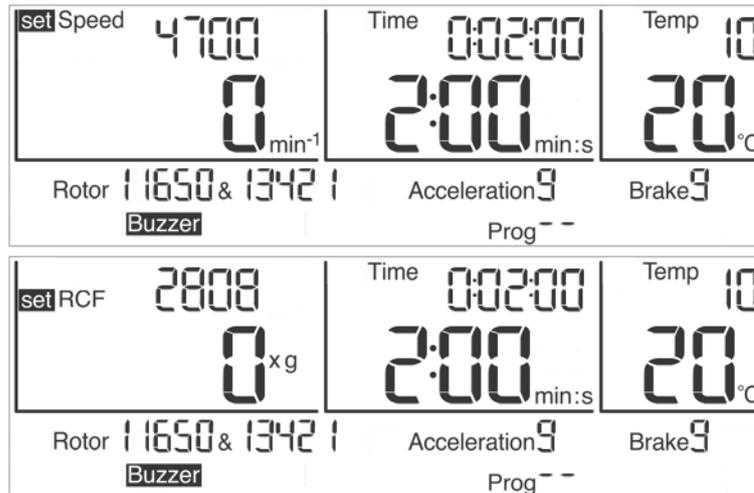
Fig. 16 : Réglage de la vitesse de rotation ou de la FCR
