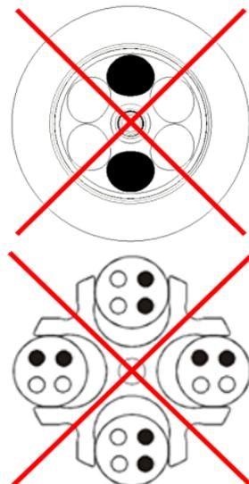
Fig. 12 : Chargement autorisé et non autorisé d'un rotor angulaire et d'un rotor libre (exemples)
