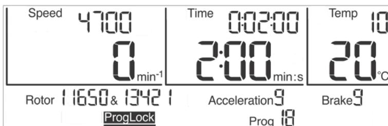
Fig. 27 : Le verrouillage du programme « ProgLock » est activé
