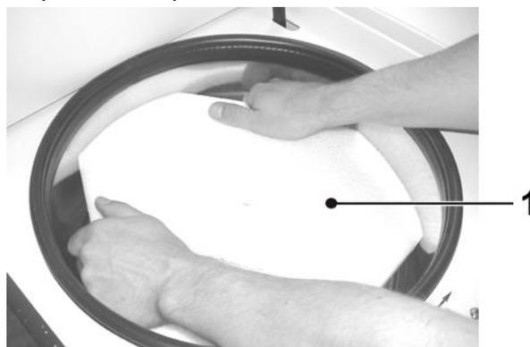
Fig. 9: Retrait du dispositif de transport (exemple)
