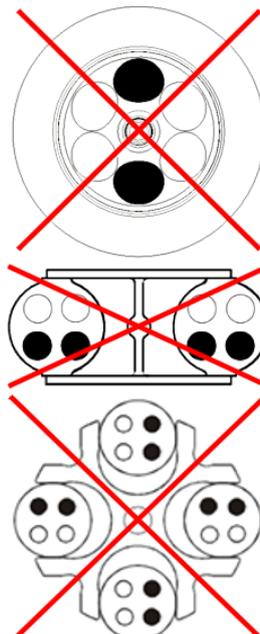
Fig. 10 : Exemples de chargements admissibles et non admissibles pour des rotors libres et angulaires
