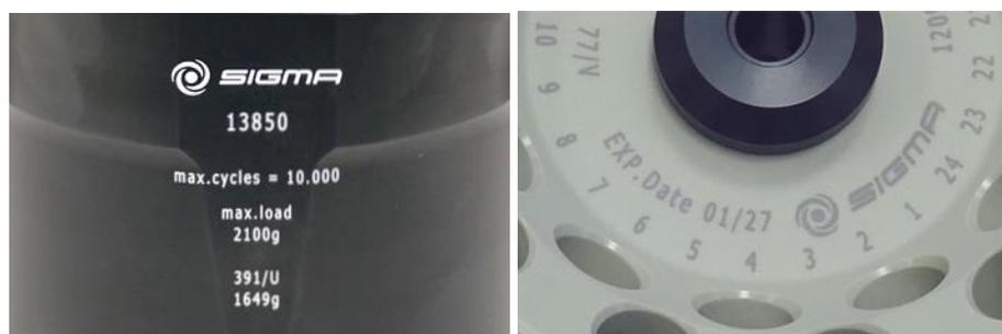
Fig. 5 : Indication de la durée de vie spécifique sur une nacelle ou un rotor
