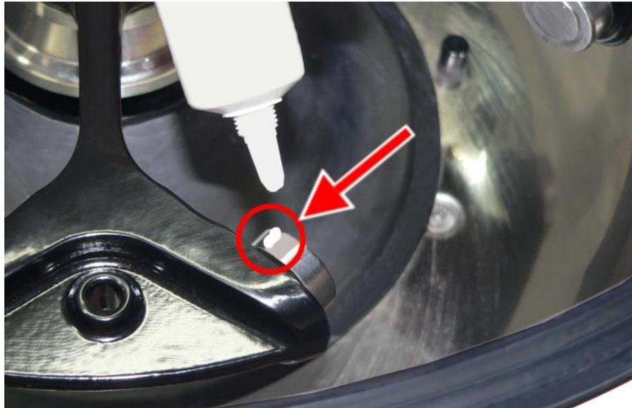
*Fig. 16 : Quantité suffisante de graisse pour un support de rotor*
