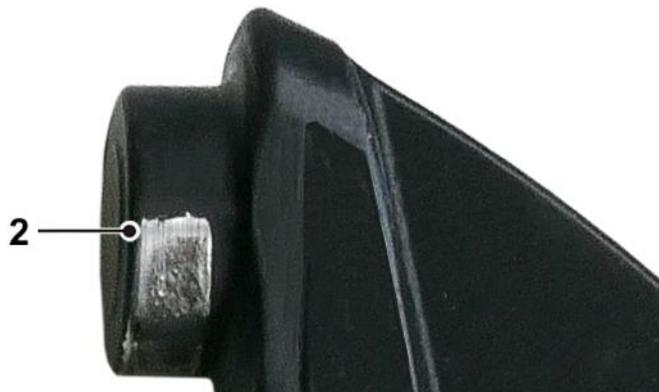
*Fig. 8 : Support de rotor avec revêtement totalement usé – Le graissage est nécessaire*
