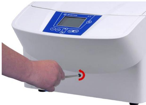
Fig. 15: Déverrouillage manuel du couvercle
