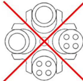
Fig. 9 : Chargement autorisé et non autorisé du rotor libre avec des récipients de tailles différentes (exemple)
