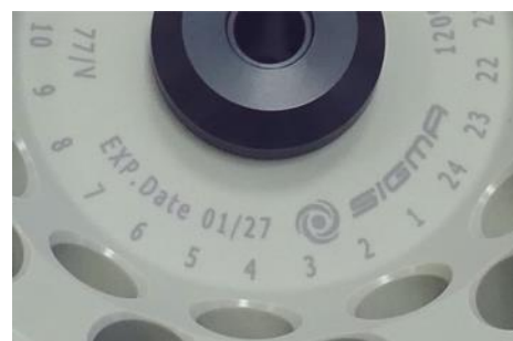
Fig.4 : Indication de la durée de vie spécifique sur une nacelle ou un rotor
