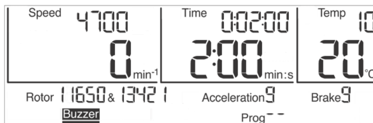
Fig. 24 : Le signal sonore « Buzzer » est activé
