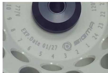
Fig.5 : Indication de la durée de vie spécifique sur une nacelle ou un rotor
