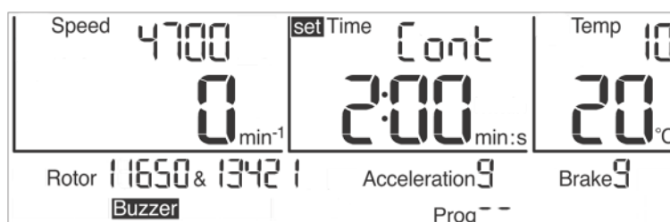
Fig. 18 : Indication « Cont » en fonctionnement continu
