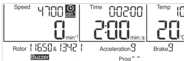
Fig. 17 : La fonction « Durée à partir de la vitesse de consigne » est activée.
