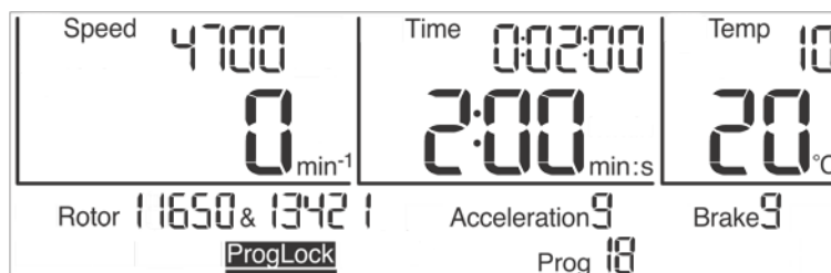
Fig. 25 : Le verrouillage du programme « ProgLock » est activé
