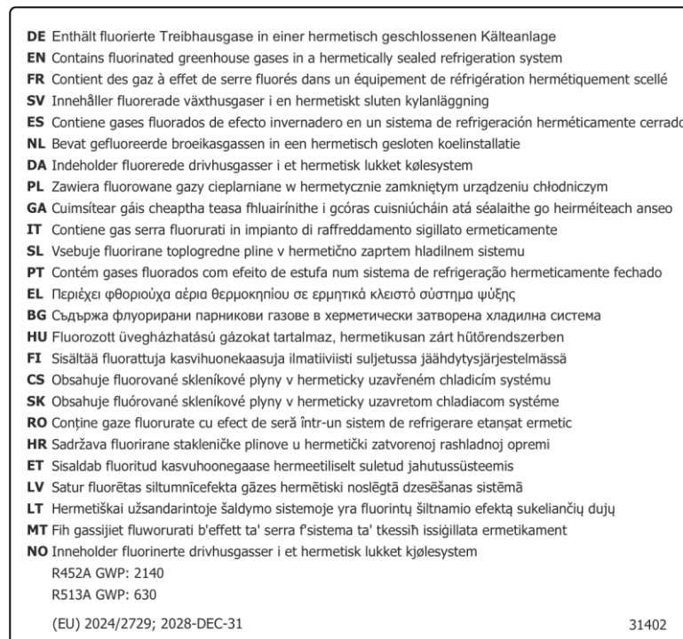
Fig. 4 : Étiquette relative aux gaz à effet de serre fluorés conforme au règlement européen (UE) 2024/2729
