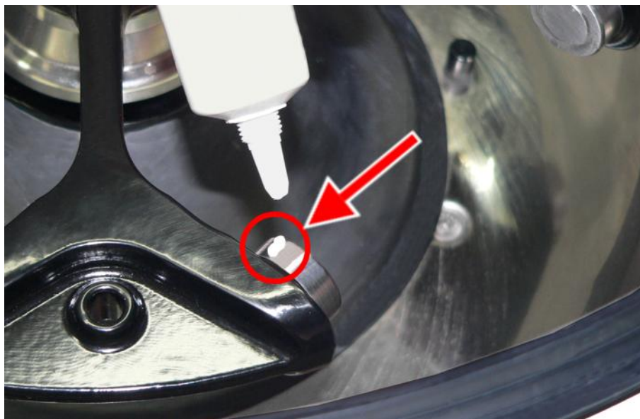
Fig. 32 : quantité suffisante de graisse pour un support de rotor
