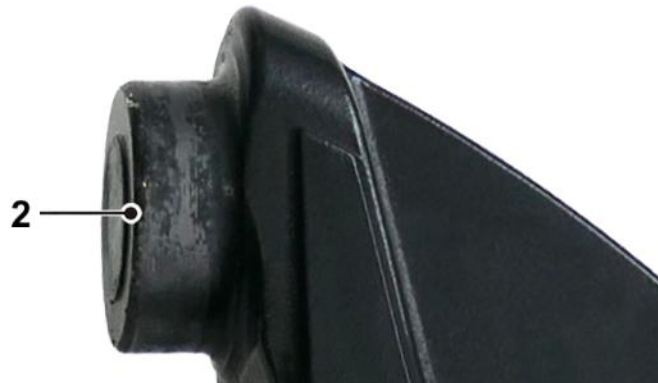
Fig. 7 : Support de rotor avec traces d'usage – Aucun graissage n'est nécessaire
