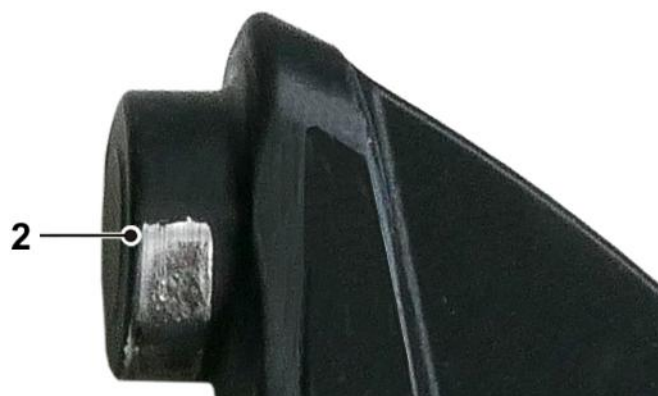
Fig. 8 : Support de rotor avec revêtement usé – Le graissage est nécessaire
