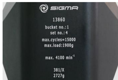
Fig.5 : Indication de la durée de vie spécifique sur une nacelle ou un rotor
