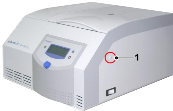
Fig. 31 : Emplacement du dispositif de déverrouillage d'urgence
