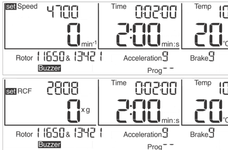
Fig. 15 : Réglage de la vitesse de rotation ou de la FCR
