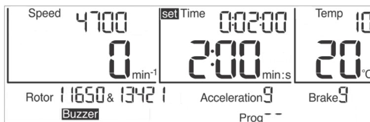
Fig. 16 : Réglage de la durée, ici avec l'unité « min:s »
