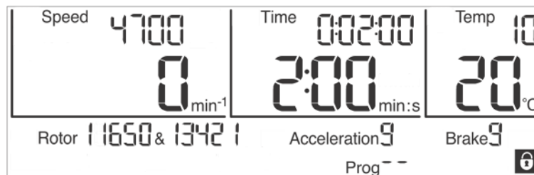
Fig. 28 : Symbole du cadenas lorsque le verrouillage du paramétrage est activé
