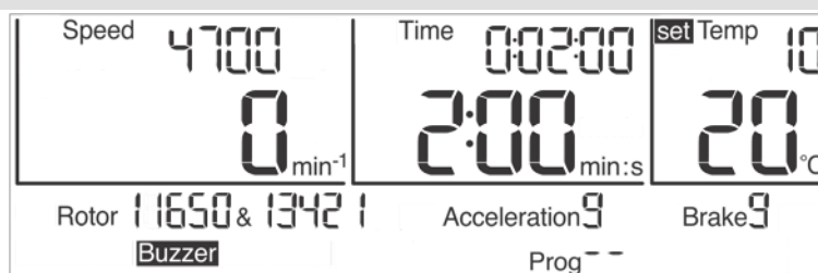
Fig. 19 : Réglage de la température de consigne
