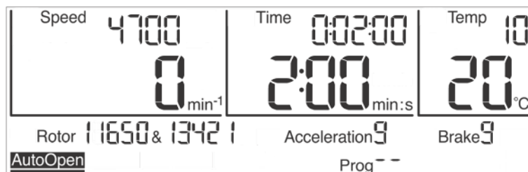
Fig. 23 : L'ouverture automatique du couvercle « Auto Open » est activée
