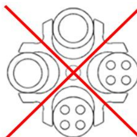
Fig. 9 : Chargement autorisé et non autorisé du rotor libre avec des récipients de tailles différentes (exemple)
