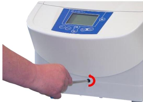
Fig. 11: Déverrouillage manuel du couvercle
