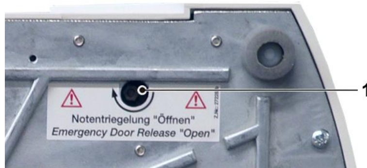
Fig. 14 : Orifice pour le déverrouillage d'urgence, situé sous la centrifugeuse
