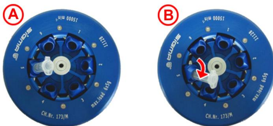
Fig. 8 : Insertion des grands tubes
