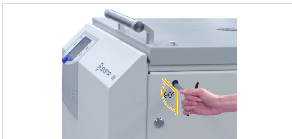
Fig. 42: La llave de desbloqueo de emergencia se debe insertar horizontalmente
