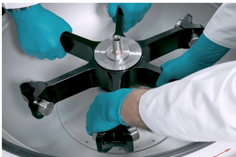
Fig. 18: Elevación correcta del rotor 11805 con cuba guardavientos
