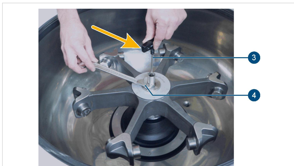
Fig. 12: «Técnica de dos dedos» para sujetar la llave Allen
