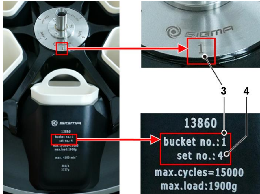
Fig. 9: Número de vaso y de juego en el vaso y número de vaso en el rotor
