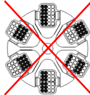
Fig. 16: Carga permitida y no permitida de rotores angulares y oscilantes (ejemplo)
