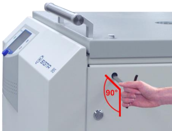
Fig. 41: La llave de desbloqueo de emergencia se debe insertar horizontalmente
