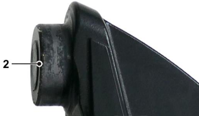
Fig. 7: Perno de soporte con signos de uso – no se requiere engrasado
