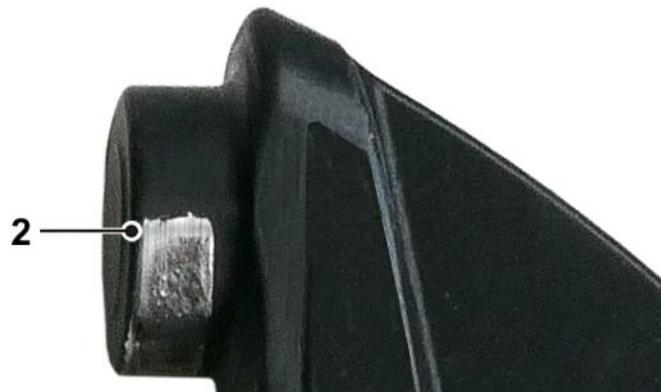
*Fig. 9: Perno de soporte con recubrimiento deslizante completamente desgastado - se requiere engrasado*
