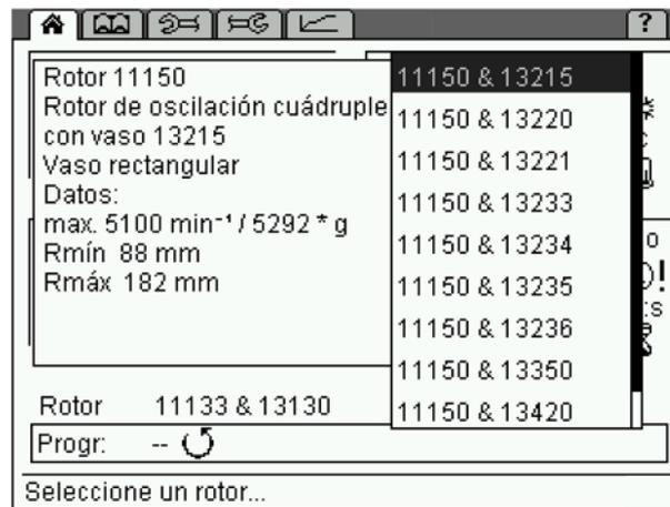
Fig. 20: Lista de selección de los rotores; en este caso para un rotor oscilante
