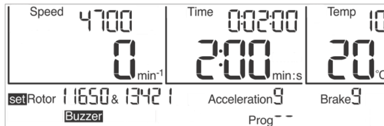
Fig. 24: Selección del rotor o de la combinación de rotor y vaso
