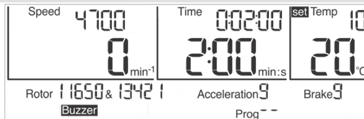
Fig. 22: Ajuste de la temperatura nominal
