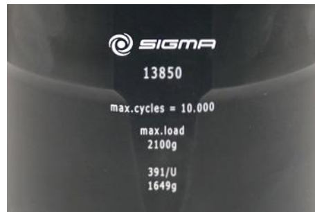
Fig. 6: Distinta vida útil – grabado en el vaso / rotor
