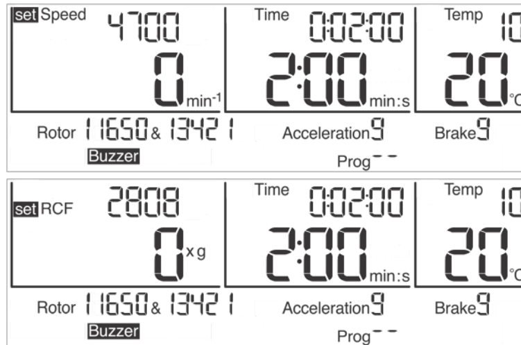
Fig. 17: Ajuste del número de revoluciones o de la ACR
