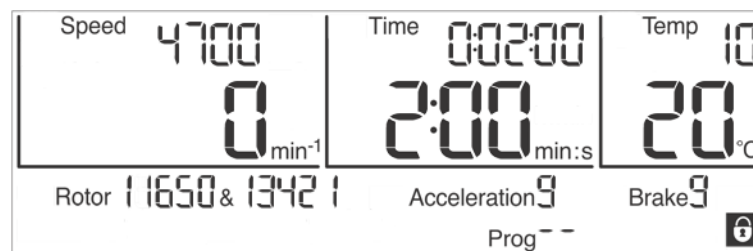
Fig. 31: Símbolo "Candado" con el bloqueo de entrada activado
