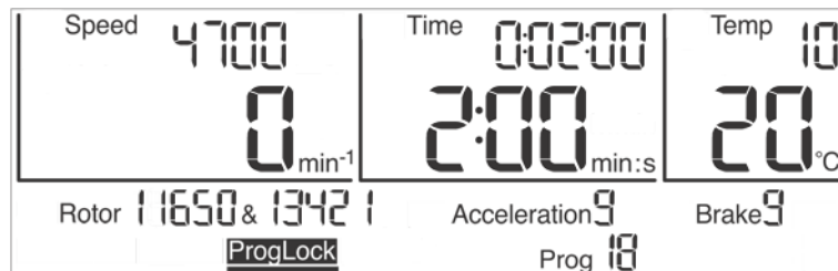
Fig. 28: El bloqueo de programas "ProgLock" está activado
