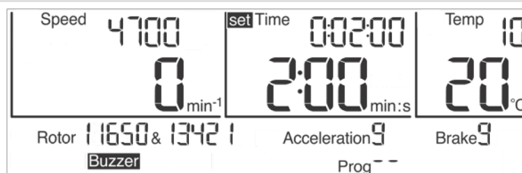
Fig. 18: Ajuste del tiempo de ejecución; en este caso con la unidad "min:s"
