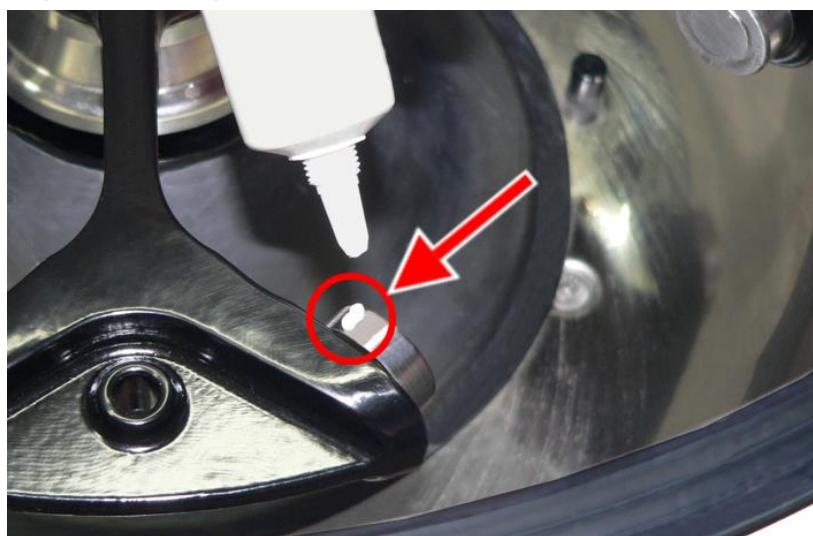
Fig. 1: Cantidad suficiente de grasa para pernos de soporte para un perno
