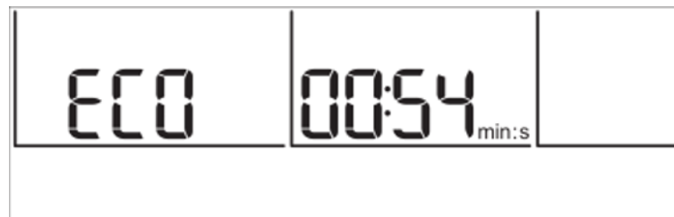
Fig. 32: Indicación de los últimos 29 minutos de la cuenta atrás hasta la activación del modo Eco
