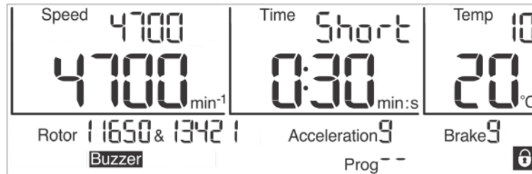
Fig. 21: Indicación "Short" durante el funcionamiento de corta duración
