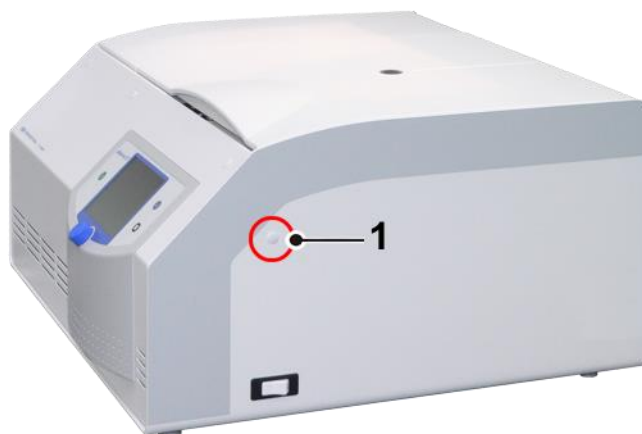
Fig. 33: Posición del orificio para el desbloqueo de emergencia
