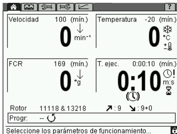
Fig. 15: Menú de inicio; en este caso con indicación de todos los símbolos posibles
