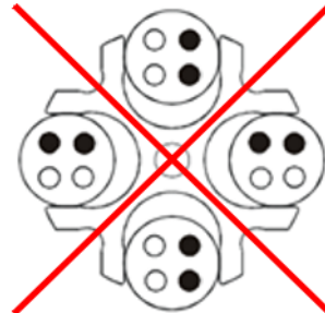
Fig. 11: Carga permitida y no permitida de rotores angulares y oscilantes (ejemplo)
