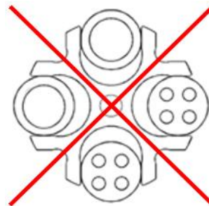
Fig. 10: Carga permitida y no permitida del rotor oscilante con diferentes tamaños de vasos (ejemplo)
