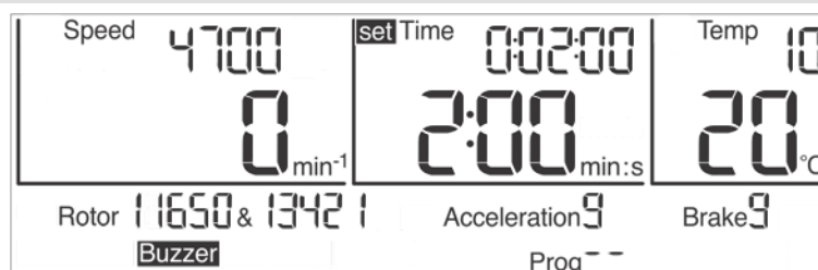
Fig. 17: Ajuste del tiempo de ejecución; en este caso con la unidad "min:s"
