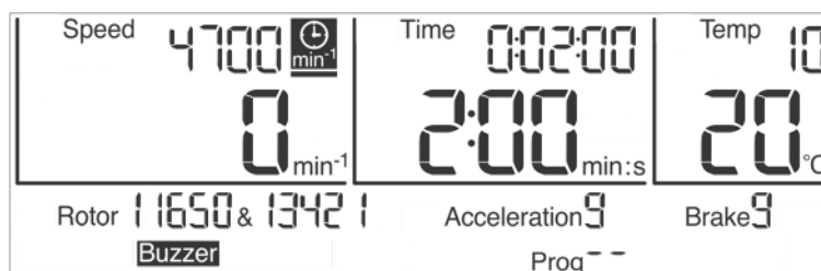
Fig. 18: Está activada la función "Tiempo de ejecución a partir de velocidad nominal"
