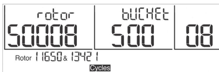
Fig. 29: Indicación de que se ha alcanzado el número máximo de ciclos (intermitente)
