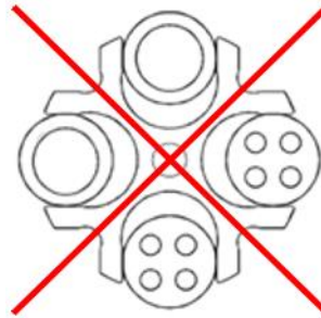
Fig. 11: Carga permitida y no permitida del rotor oscilante con diferentes tamaños de vasos (ejemplo)
