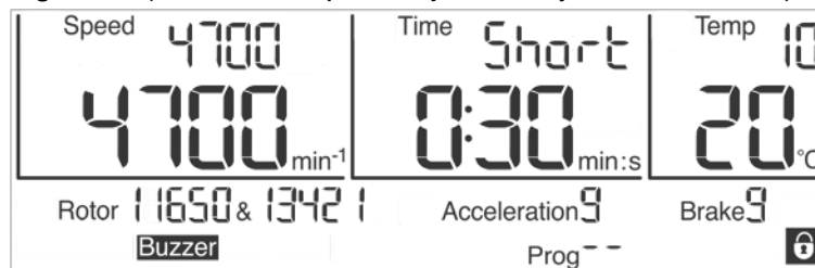
Fig. 20: Indicación "Short" durante el funcionamiento de corta duración
