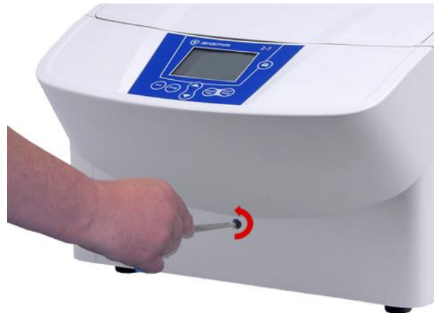
Fig. 15: Desbloqueo manual del cierre de la tapa
