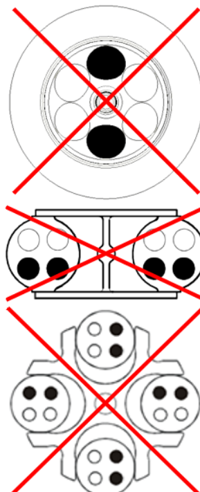
Fig. 10: Carga permitida y no permitida de rotores angulares y oscilantes (ejemplo)
