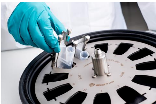
Fig. 13: Colocación del sistema de cámara de muestras
