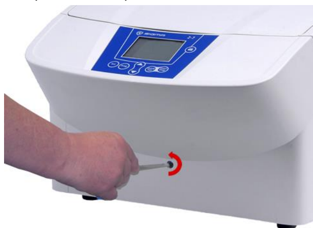
Fig. 23: Desbloqueo manual del cierre de la tapa
