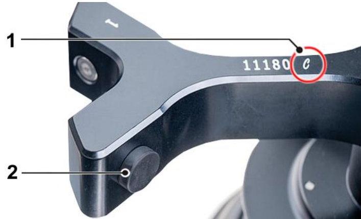
Fig. 5: Identificación de un rotor con recubrimiento Comfort (ejemplo)
