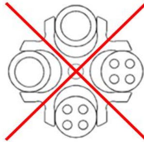
Fig. 9: Carga permitida y no permitida del rotor oscilante con diferentes tamaños de vasos (ejemplo)
