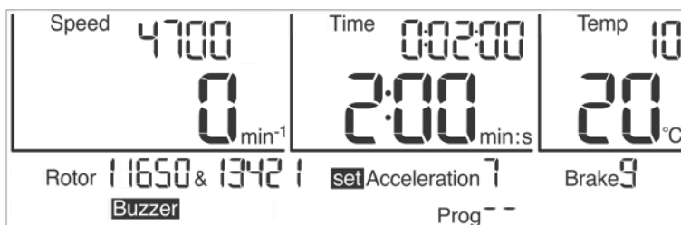
Fig. 22: Selección de curva; en este caso, selección de la curva de aceleración
