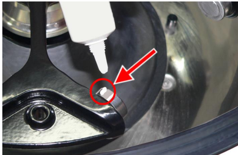
Fig. 1: Cantidad suficiente de grasa para pernos de soporte para un perno
