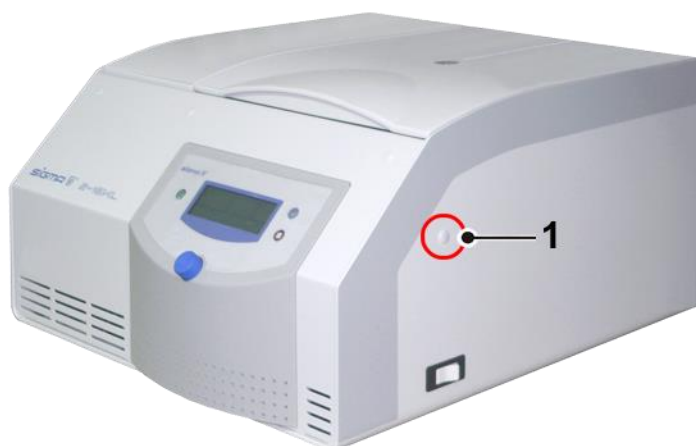
Fig. 31: Posición del orificio para el desbloqueo de emergencia
