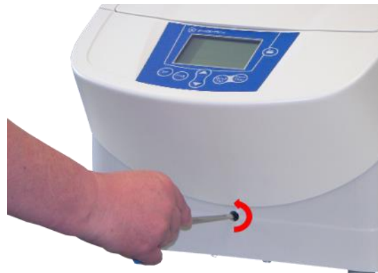
Fig. 9: Desbloqueo manual del cierre de la tapa
