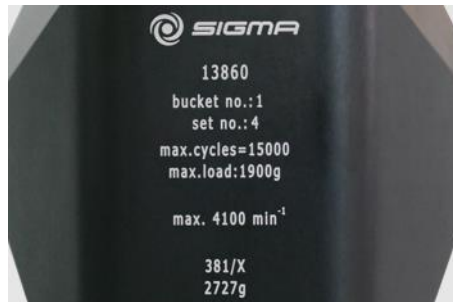
Fig. 4: Distinta vida útil – grabado en el vaso / rotor
