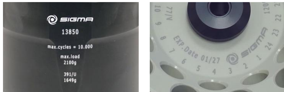
Fig. 4: Distinta vida útil – grabado en el vaso / rotor
