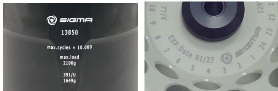
Fig. 5: Distinta vida útil – grabado en el vaso / rotor
