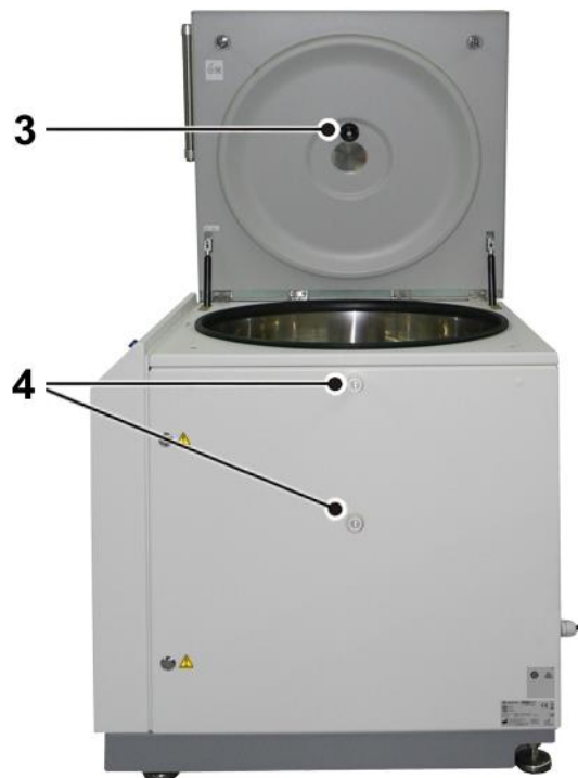
Abb. 11: Ablagemöglichkeiten für den Deckel des Windschutzkessels
