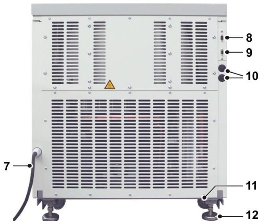
Abb. 4: Rückseite einer Zentrifuge mit Luftkühlung
