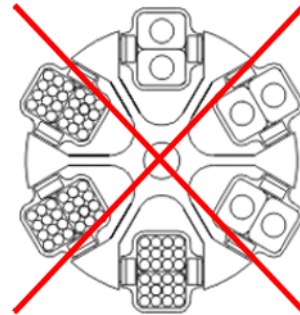
Abb. 15: Zulässige und unzulässige Beladung eines Ausschwingrotors mit unterschiedlichen Gläsergrößen (Beispiel)
