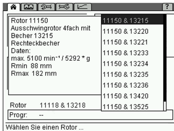
Abb. 22: Rotorauswahlliste, hier für einen Ausschwingrotor
