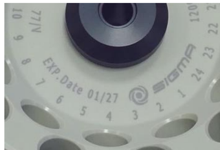
Abb. 7: abweichende Lebensdauer – Gravur auf dem Becher / Rotor (Beispiele)
