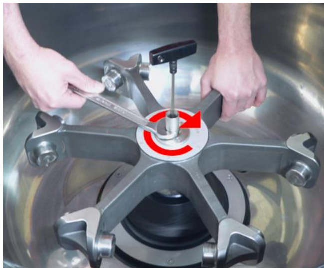
Abb. 14: Befestigung des Rotors
