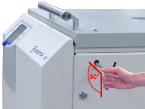
Abb. 41: Der Notentriegelungsschlüssel muss waagrecht eingesteckt werden
