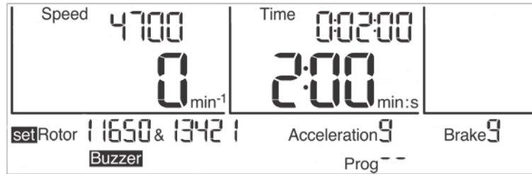
Abb. 25: Auswählen des Rotors bzw. der Rotor-Becher-Kombination
