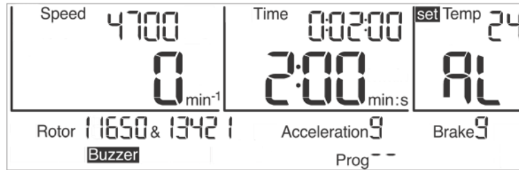
Abb. 23: Anzeige mit aktivierter Temperaturüberwachung
