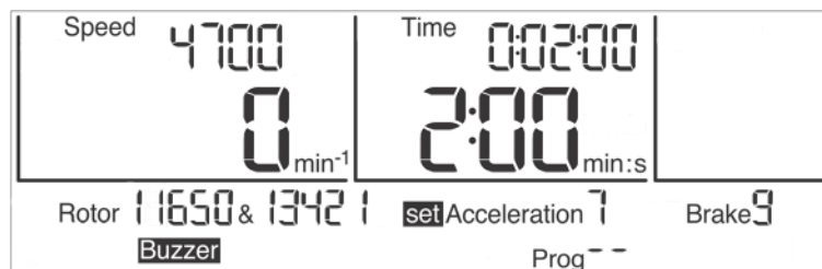
Abb. 26: Kurvenauswahl; hier: Auswahl der Beschleunigungskurve
