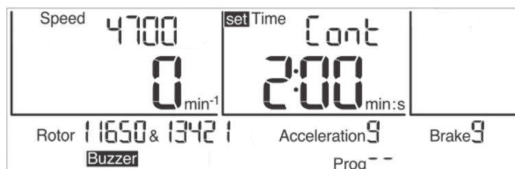
Abb. 20: Anzeige "Cont" bei Dauerbetrieb
