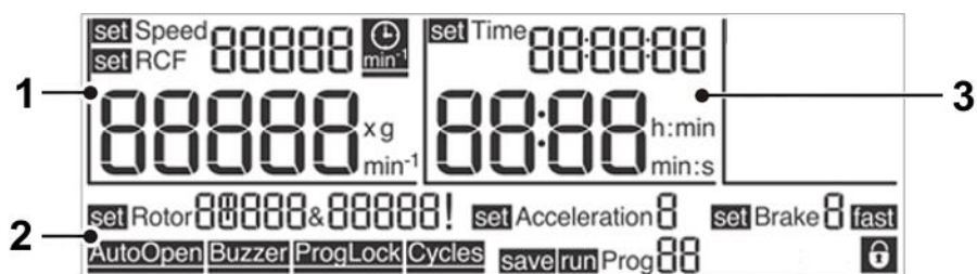
Abb. 15: Display der Steuerung "Spincontrol L", Sigma 4-5L
