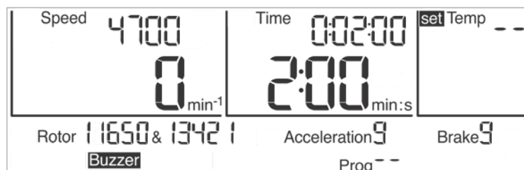
Abb. 22: Anzeige mit deaktivierter Temperaturüberwachung
