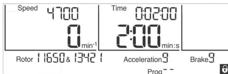
Abb. 32: Symbol "Vorhängeschloss" bei aktivierter Eingabesperre
