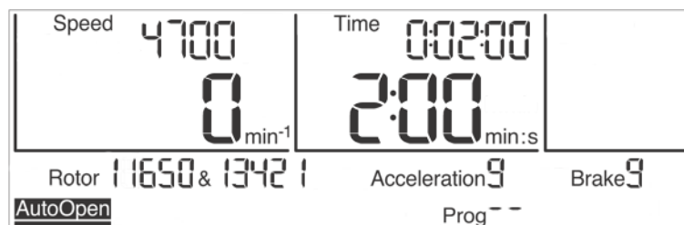
Abb. 27: Die automatische Deckelöffnung "Auto Open" ist aktiviert
