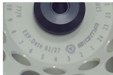
Abb. 6: abweichende Lebensdauer – Gravur auf dem Becher / Rotor
