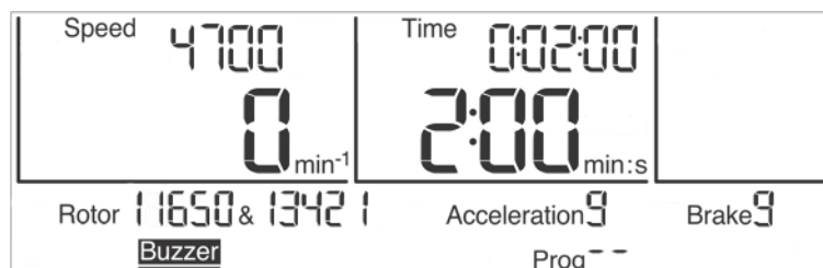
Abb. 28: Das akustische Signal "Buzzer" ist aktiviert
