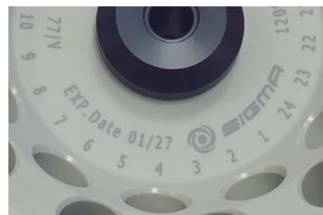
Abb. 7: abweichende Lebensdauer – Gravur auf dem Becher / Rotor
