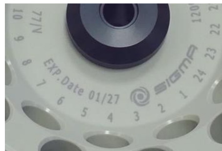
Abb. 5: abweichende Lebensdauer – Gravur auf dem Becher / Rotor (Beispiele)
