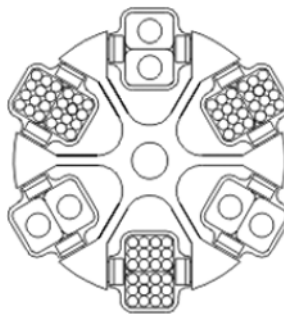
Abb. 11: Zulässige und unzulässige Beladung des Ausschwingrotors mit unterschiedlichen Gläsergrößen (Beispiele)
