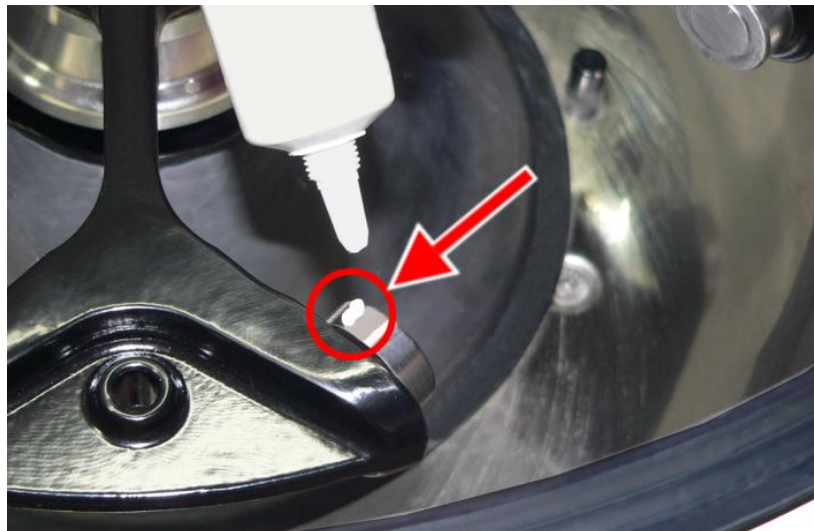
Abb. 36: ausreichende Menge Tragbolzenfett für einen Bolzen
