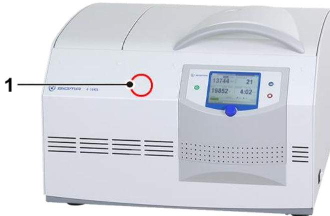
Abb. 34: Position der Öffnung für die Notentriegelung
