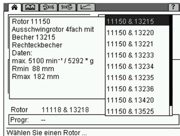
Abb. 18: Rotorauswahlliste, hier für einen Ausschwingrotor
