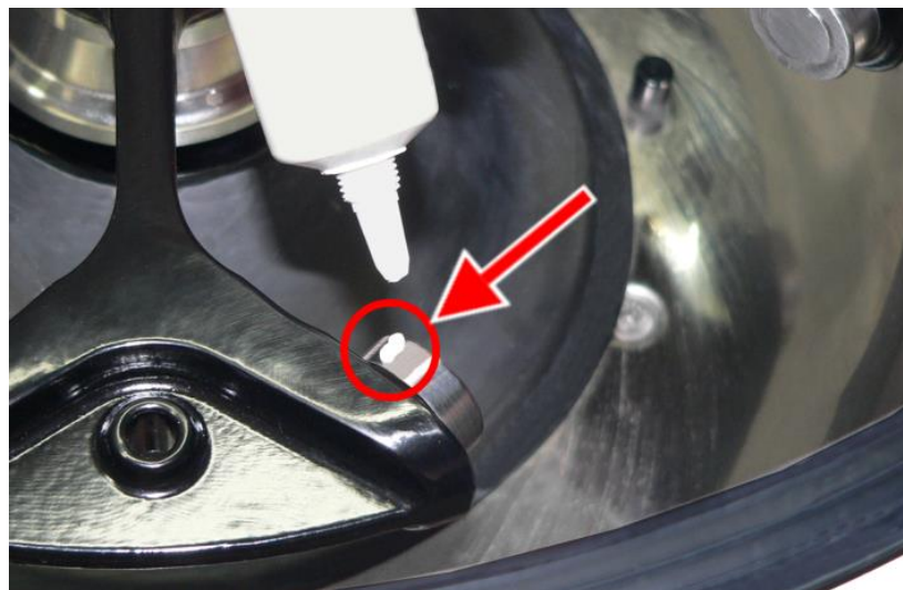
Abb. 37: ausreichende Menge Tragbolzenfett für einen Bolzen
