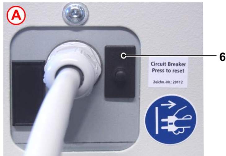
Abb. 4: Detailansicht A - Netzeingangswinkel
