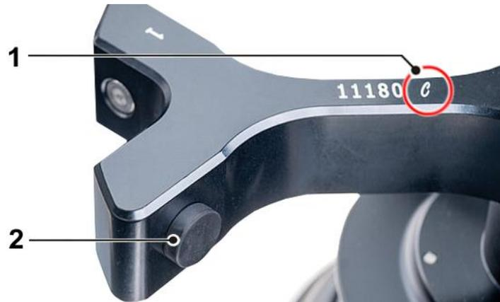
Abb. 5: Kennzeichnung eines Rotors mit Comfort Rotorbeschichtung (Beispiel)
