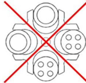
Abb. 10: Zulässige und unzulässige Beladung des Ausschwingrotors mit unterschiedlichen Gläsergrößen (Beispiel)
