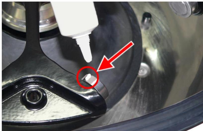
Abb. 34: ausreichende Menge Tragbolzenfett für einen Bolzen
