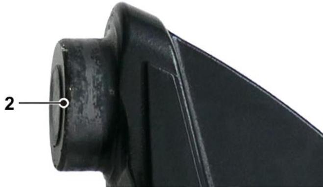
Abb. 6: Tragbolzen mit Gebrauchsspuren – Fetten ist nicht notwendig
