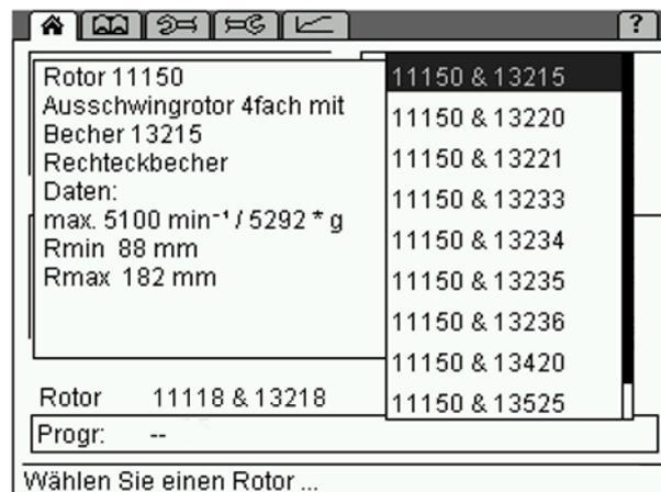
Abb. 16: Rotorauswahlliste, hier für einen Ausschwingrotor
