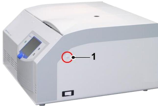
Abb. 33: Position der Öffnung für die Notentriegelung
