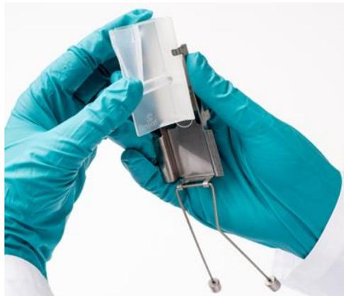
Abb. 11: Einweg-Probenkammer einsetzen
