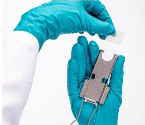
Abb. 10: Objektträger einlegen.
