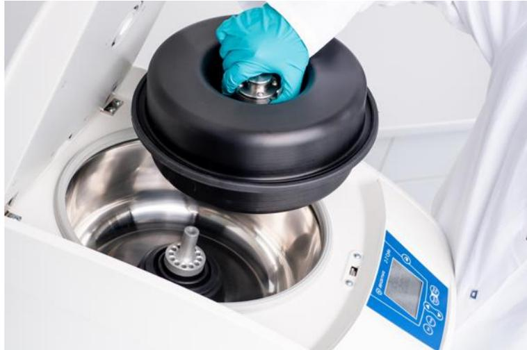
Abb. 15: Einsetzen des Zytologierotors
