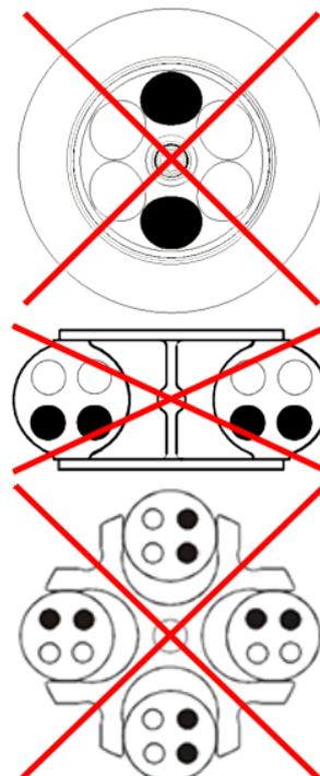
Abb. 19: Zulässige und unzulässige Beladung von Winkel- und Ausschwingrotoren (Beispiele)
