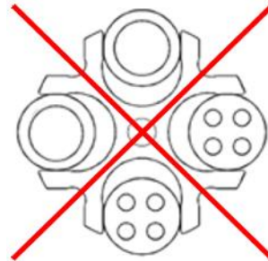
Abb. 9: Zulässige und unzulässige Beladung des Ausschwingrotors mit unterschiedlichen Gefäßgrößen (Beispiel)
