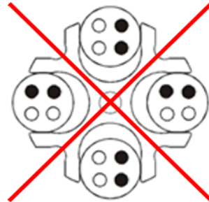
Abb. 10: Zulässige und unzulässige Beladung von Winkel- und Ausschwingrotoren (Beispiele)
