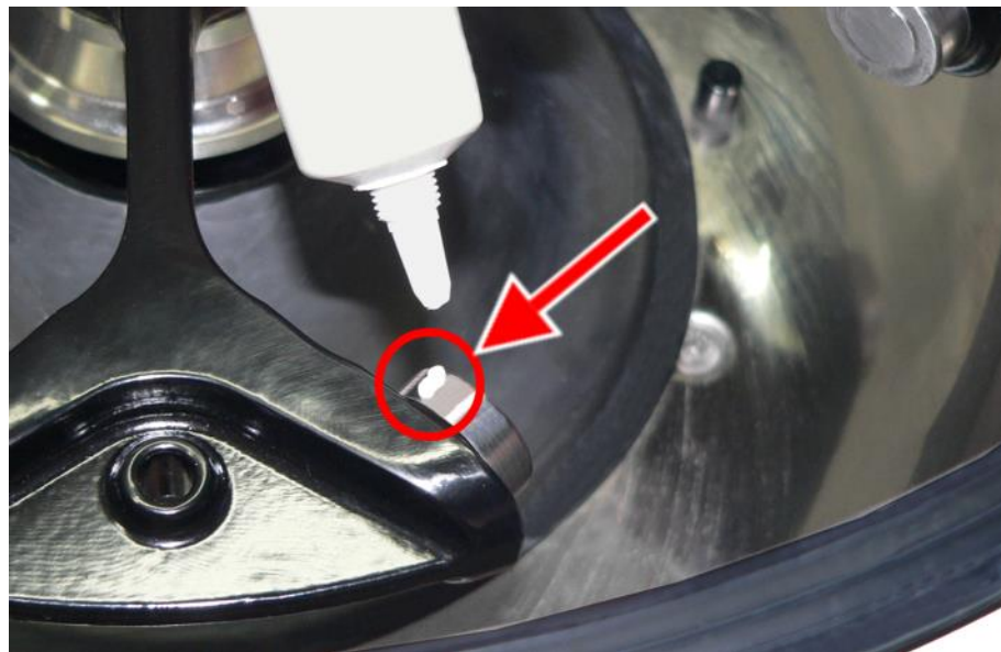
Abb. 25: ausreichende Menge Tragbolzenfett für einen Bolzen
