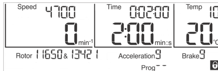
Abb. 28: Symbol "Vorhängeschloss" bei aktivierter Eingabesperre
