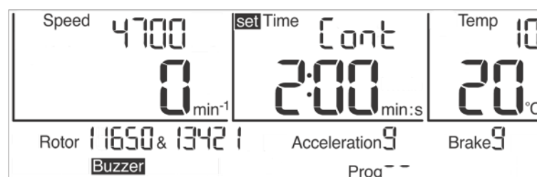
Abb. 17: Anzeige "Cont" bei Dauerbetrieb
