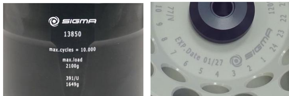
Abb. 4: abweichende Lebensdauer – Gravur auf dem Becher / Rotor (Beispiele)
