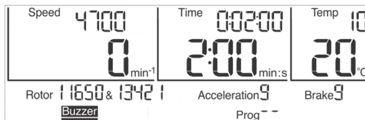
Abb. 24: Das akustische Signal "Buzzer" ist aktiviert
