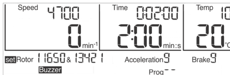
Abb. 21: Auswählen des Rotors bzw. der Rotor-Becher-Kombination
