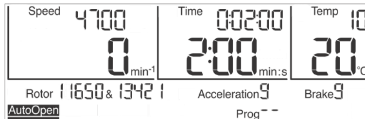
Abb. 23: Die automatische Deckelöffnung "Auto Open" ist aktiviert
