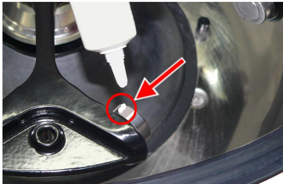
Abb. 32: ausreichende Menge Tragbolzenfett für einen Bolzen
