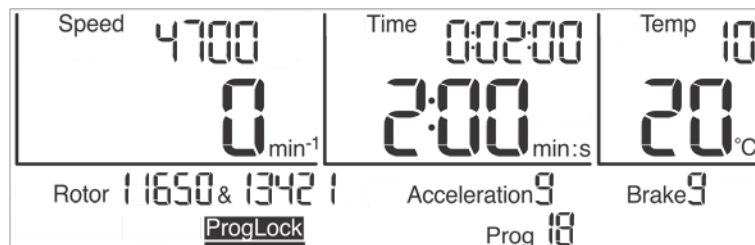
Abb. 25: Die Programmsperre "ProgLock" ist aktiviert
