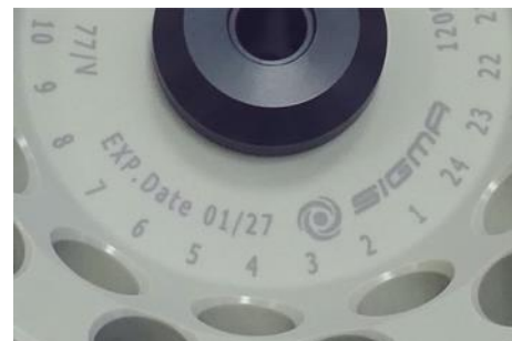
Abb. 4: abweichende Lebensdauer – Gravur auf dem Becher / Rotor (Beispiele)
