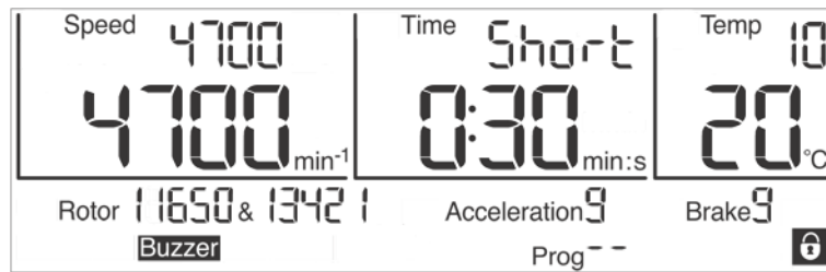
Abb. 18: Anzeige "Short" während des Kurzzeitbetriebs
