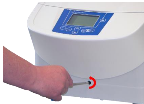
Abb. 9: Manuelle Entriegelung des Deckelschlosses
