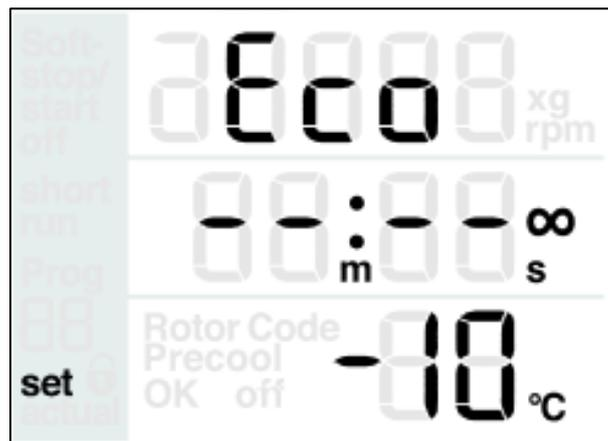
Abb. 10: Anzeige des Eco-Modus im Wechsel mit der Drehzahlanzeige
