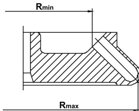
Abb. 15: Minimal- und Maximalradius eines Winkelrotors
