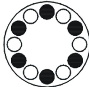
Abb. 7: Zulässige und unzulässige Beladung eines Winkelrotors (Beispiel)
