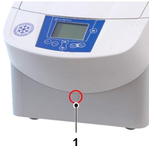
Abb. 13: Position der Öffnung für die Notentriegelung
