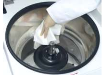
Abb. 1: Reinigung der Rotorkammer
