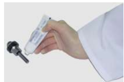
Abb. 4: Fetten der Rotorbefestigungsschraube
