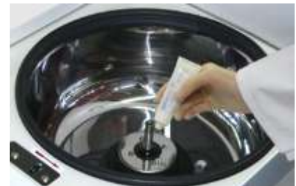
Abb. 3: Fetten der Motorwelle (sehr dünne Schicht)
