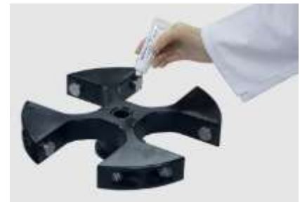
Abb. 2: Fetten der Tragbolzen (sehr dünne Schicht) bei Verwendung von Aluminiumzubehör
