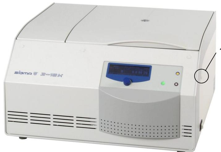
Abb. 7.2: Position der Öffnung für die Notentriegelung
