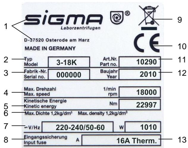
Abb. 2.3: Beispiel eines Typenschildes
