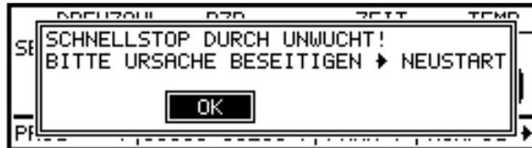
Der Lauf kann nicht mehr fortgesetzt werden (Unwucht > Abschaltsschwelle). Die Zentrifuge wird mit max. Bremsleistung gestoppt.
