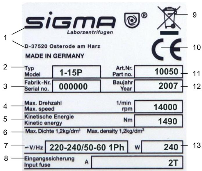
Abb. 5.4: Beispiel eines Typenschildes
