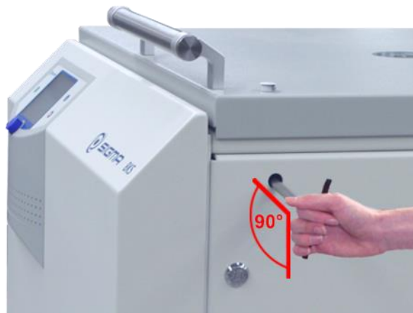
Fig. 41: La llave de desbloqueo de emergencia se debe insertar horizontalmente
