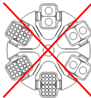
Fig. 15: Carga permitida y no permitida de un rotor oscilante con diferentes tamaños de vasos (ejemplo)
