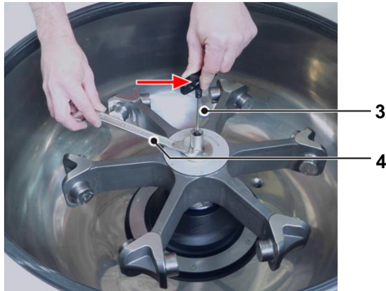
Fig. 13: "Técnica de dos dedos" para sujetar la llave Allen
