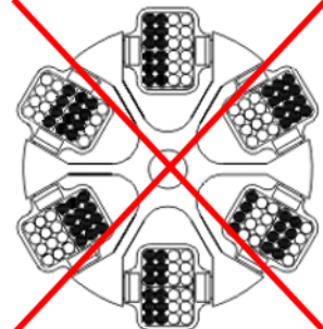
Fig. 16: Carga permitida y no permitida de rotores angulares y oscilantes (ejemplo)
