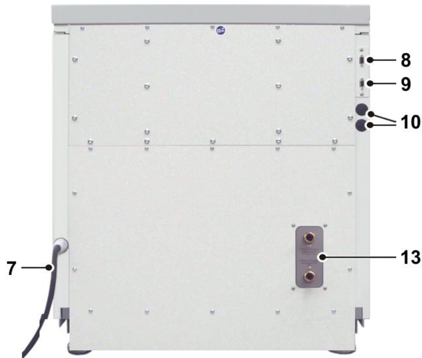
Abb. 5: Rückseite einer Zentrifuge mit Wasserkühlung
