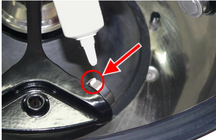
Abb. 42: ausreichende Menge Tragbolzenfett für einen Bolzen
