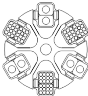
Abb. 15: Zulässige und unzulässige Beladung eines Ausschwingrotors mit unterschiedlichen Gläsergrößen (Beispiel)
