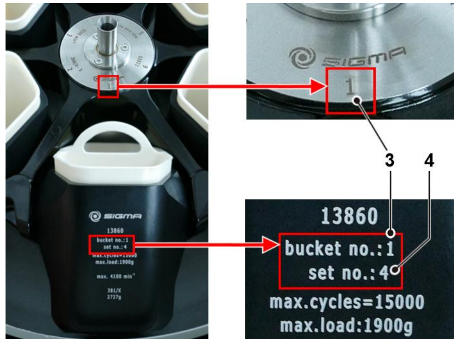
Abb. 9: Becher- und Satznummer am Becher und Bechernummer am Rotor
