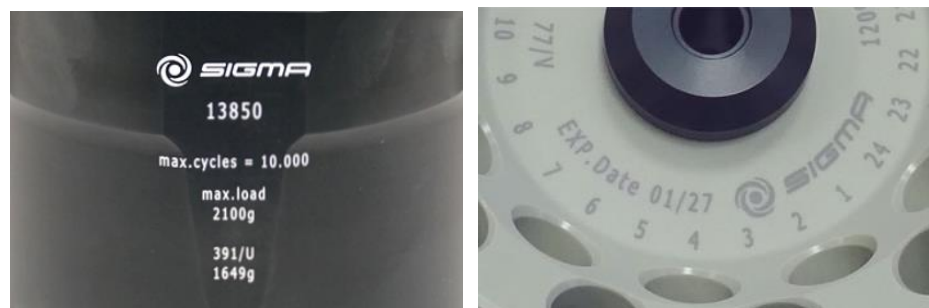
Abb. 7: abweichende Lebensdauer – Gravur auf dem Becher / Rotor
