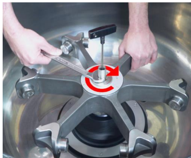
Abb. 14: Befestigung des Rotors
