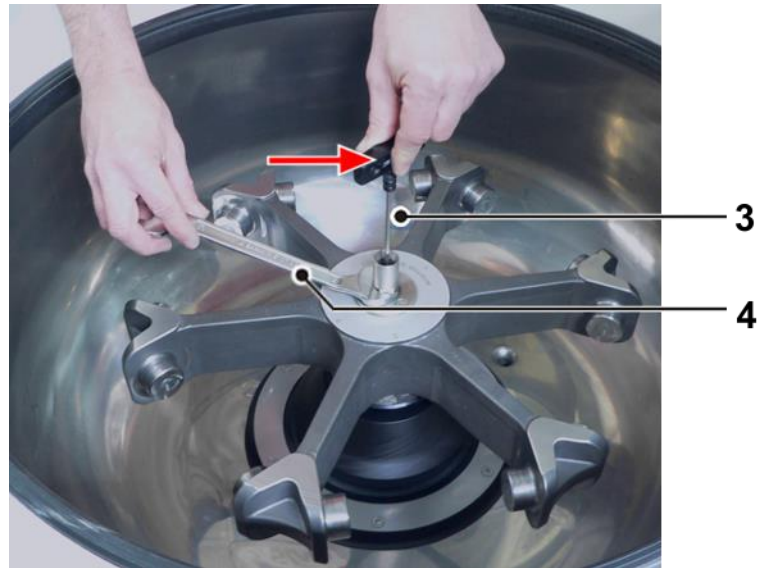
Abb. 13: "Zwei-Finger-Prinzip" beim Halten des Innensechskantschlüssels
